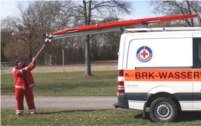
Der Rettungsbrettträger ist hydraulisch unterstützt, es ist aber notwendig, das Absenken des Rettungsbrettträgers zu unterstützen.
