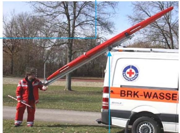
den Rettungsbretträger zuerst mit dem Griff und dann mit der Bedienstange wieder in die Fahrposition zurückschieben bis die Sicherheitssperriegel auf beiden Seiten in die Sicherheitsverschlussbolzen sicher einrasten.
