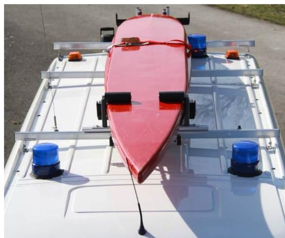
Mit einer Dach Beladung ist die Höchstgeschwindigkeit auf 100 km/h begrenzt. Da unser Einsatzzug aber mit einem Geräteanhänger oder Motorrettungsboot auf einem Bootsanhänger ausrückt ist dies nicht nachteilig.
