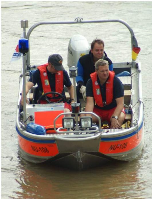
Die Zugboote sind mit einem stabilen Schleppbügel mit einer Seilführung ausgestattet. Diese verhindert, dass das Zugseil auf eine Seite verrutscht und mittig über dem Motor bleibt.
